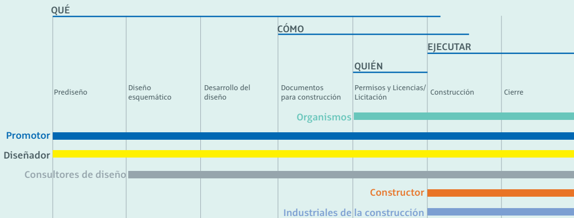
Figura 22. Proceso Tradicional del Diseño. Adaptado de Integrated Project Delivery: A Guide (2007)
