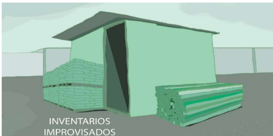
Fig. 12. Exceso de inventario en obra, lo cual origina que se improvisen almacenes ocasionando que el material quede expuesto a pérdidas, deterioros o robos.
