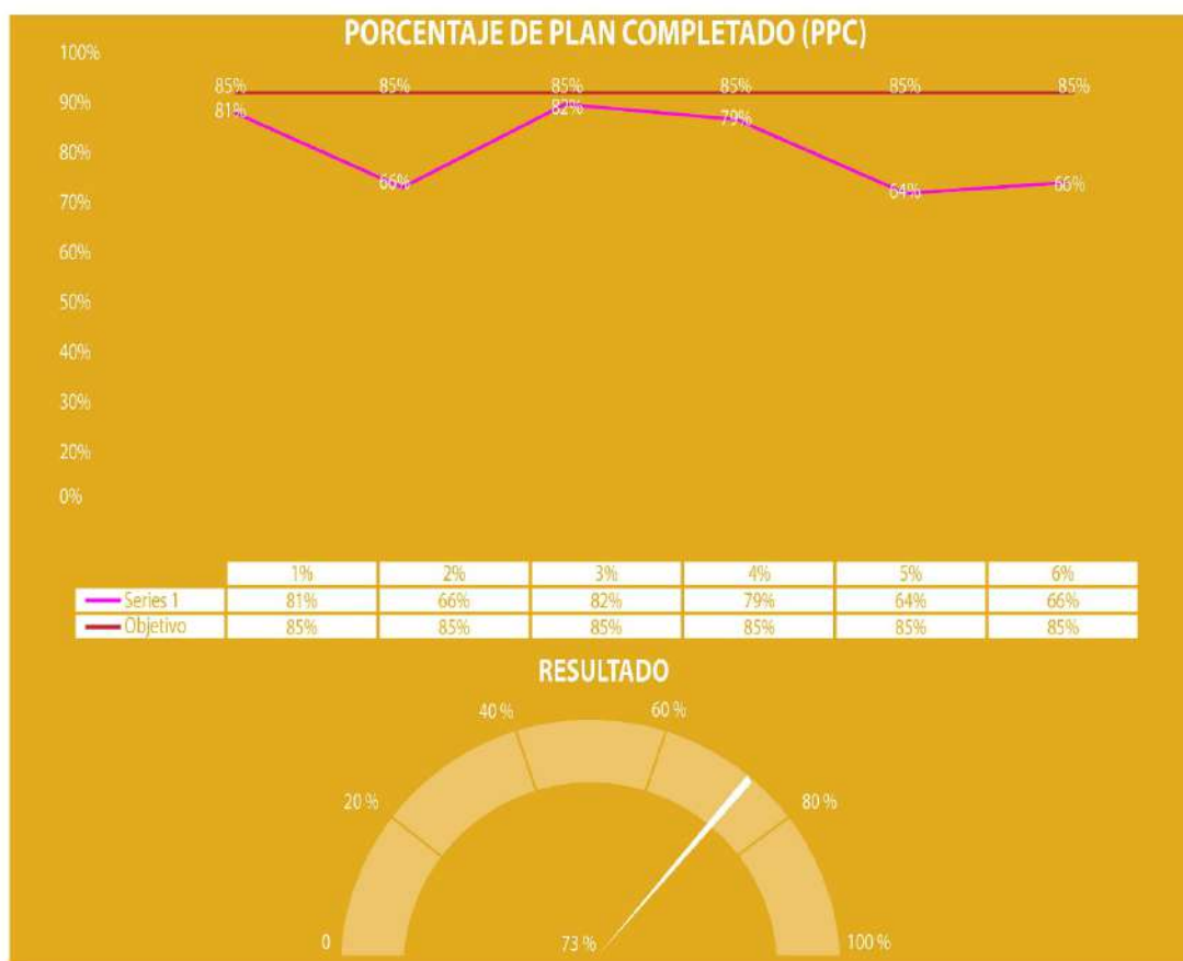
Fig. 38. Ejemplo de medición del porcentaje del plan completado, definiendo el 85% como objetivo de cumplimiento de actividades.
