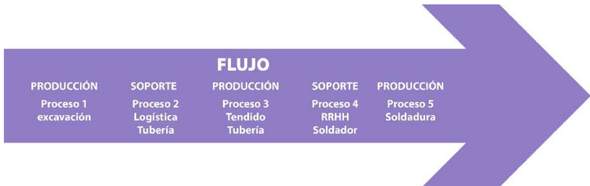
Fig. 27. Ejemplo de flujo continuo de actividades en el proceso constructivo de suministro y colocación de tubería.
